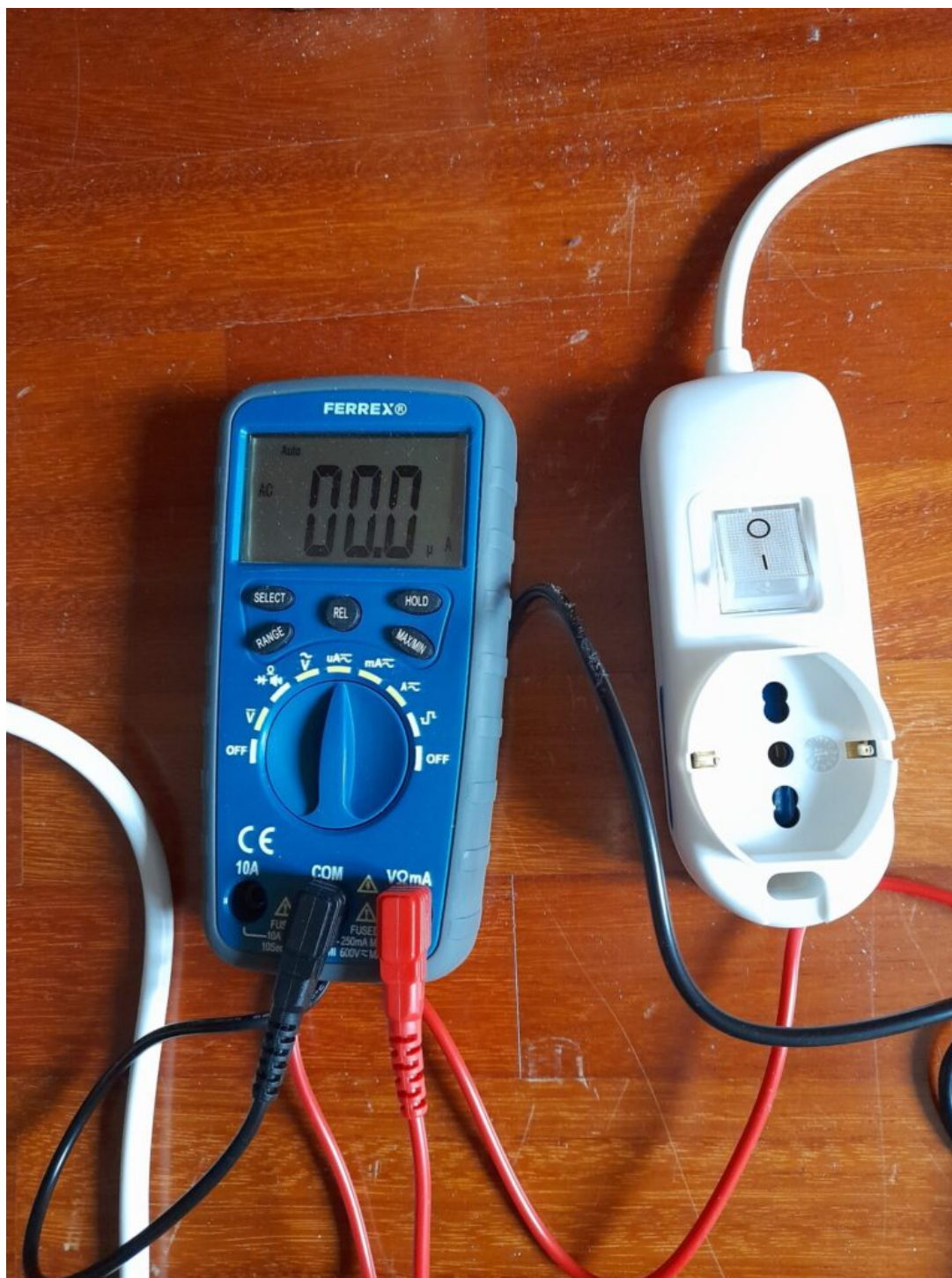
Il multimetro privo di tensione, alla massima sensibilità (uA)
