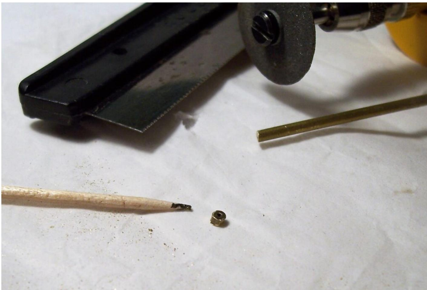
Costruzione del corpo del serbatoio del dispositivo lubrificante. – Foto dell'autore. Mediante un disco sottile si affetta il tubetto e si taglia lo spezzone di filo metallico, la cui estremità superiore simulerà il coperchio. Ovviamente, avendo a disposizione il disco abrasivo, si provvederà a togliere le asperità dovute al taglio. In seguito si perfora la superficie superiore del dispositivo, s'inserisce il filo e, a seguire, l'anello di ottone:
