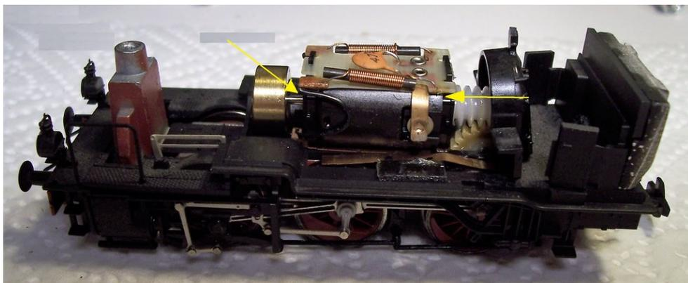
Vista dell'interno della locomotiva, con evidenziati alcuni punti di lubrificazione. – Foto dell'autore.
