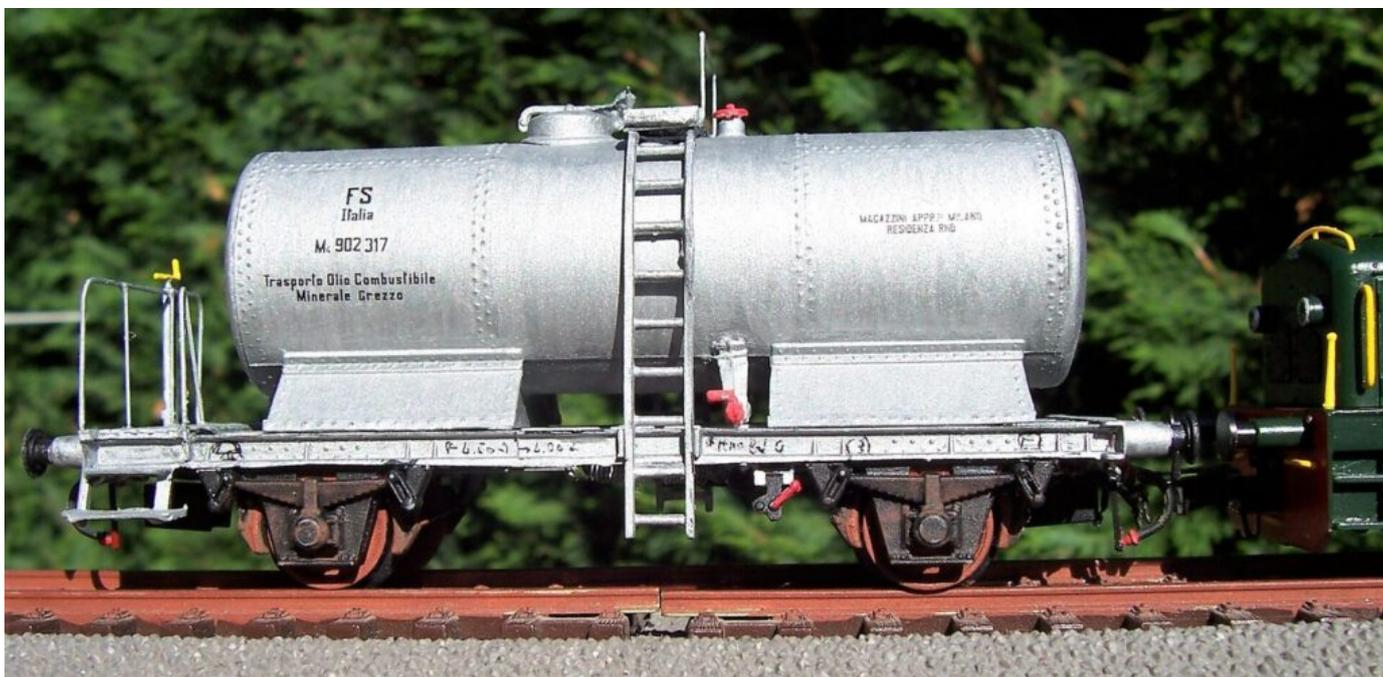
Il carro di lato, mostra il dispositivo “vuoto / carico” con il suo leveraggio. - Foto dell'autore.
